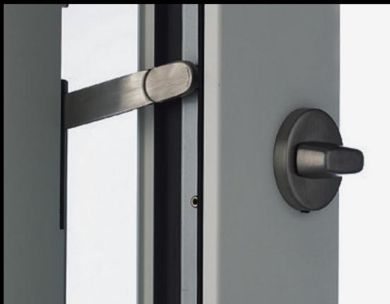
Le blocage de porte TSH tient lieu de limitation d'ouverture. Il est actionné depuis l'extérieur par la serrure principale (aucun cylindre extérieur). L'actionnement depuis l'intérieur est assuré par un bouton rotatif.
